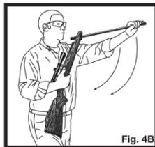
N'armez pas votre arme à air comprimé jusqu'à ce que vous soyez prêt à charger et à tirer, puisque le seul moyen de désarmer votre arme à air comprimé est de tirer. Le fait d'utiliser votre arme sans plomb dans la chambre (tir à sec) peut l'endommager.
