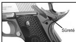
Fig. 2A - Vers le haut pour "Enclenchée" (ON)
