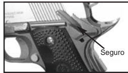
Fig. 2A - Empuje hacia arriba para activar el seguro ("ON SAFE")
