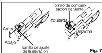
el tornillo de ajuste de elevación girándolo en el sentido de las agujas del reloj (Fig. 7).
